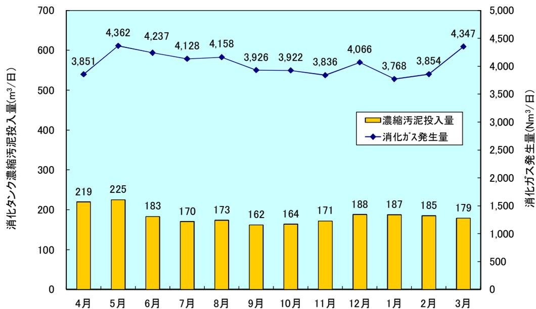
濃縮汚泥投入量の変動に合わせて消化ガス発生量が変動している。
